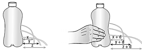
(a) Tiada tekanan tambahan dikenakan ke atas air (b) Tekanan tambahan dikenakan ke atas air
